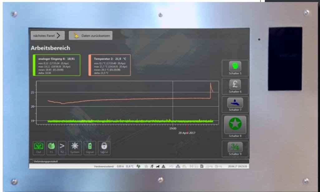
Eine Visualisierung, installiert auf einem handelsüblichen im Edelstahlgehäuse verbauten Tablet-PC
